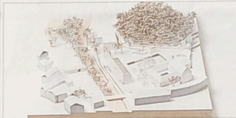
Im Bild ein Modell des Siegerprojekts, angesiedelt im Kapuzinergarten. Der Hauptbau verläuft parallel zum Tinnebach (Bildmitte). Das Dach des erdgeschossigen Sockelbaus wird begrünt und ist begehrbar. Ivo Corrà
